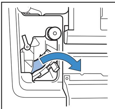
**4** Vuelva la lengüeta a su posición original y gire la Palanca de Bloqueo de la Transferencia hacia la derecha.
