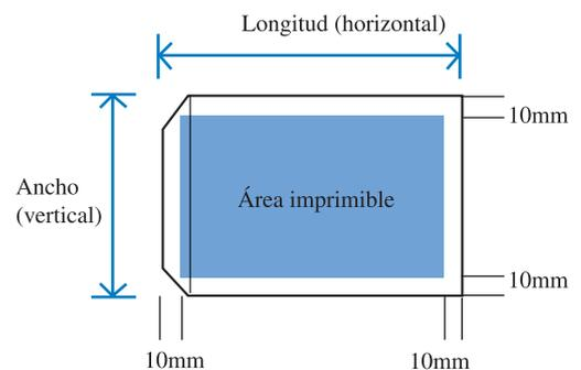
📢 Al crear los datos para la impresión de sobres, tenga cuidado de que el área de impresión no sobresalga de las solapas. Si los datos originales se imprimen en las áreas señaladas con líneas oblicuas, la correa interior de la impresora se ensuciará, lo que ocasionará inconvenientes.
