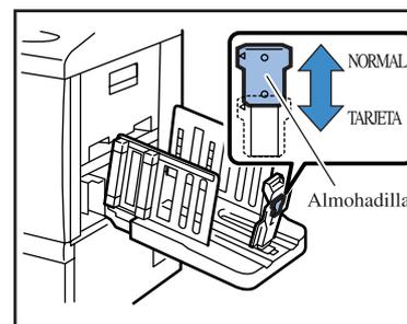
**!** Cuando imprima en papel con dimensiones superiores a 320mm x 432 mm , pliegue las guías.
