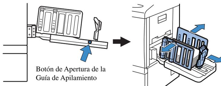
Cuando retire el papel de impresión de la bandeja receptora de papel, pulse este botón para extender las guías de apilamiento y así poder retirar el papel fácilmente.
