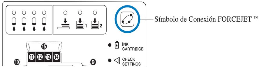
Si el control del color no funciona como debiera, por ejemplo, debido a que no se haya puesto un cartucho determinado de tinta, el Símbolo de Conexión FORCEJET™ se apaga. En ese momento, compruebe el estado de los consumibles y los diferentes ajustes.
