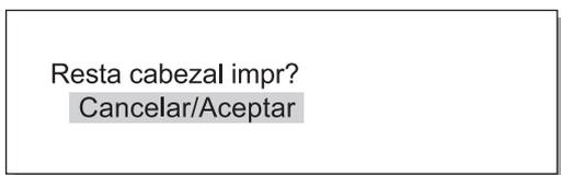
La limpieza se realiza cuando parpadea el mensaje "Limpiando cabezal?". Una vez completa la limpieza, aparece nuevamente la pantalla en el paso 2. Para salir de la configuración, pulse el botón IMPRIMIR/PAUSA.
